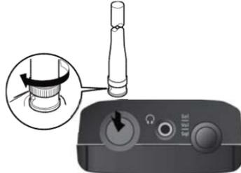
Sie verbinden die mitgelieferte Antenne indem Sie die Antenne auf die Buchse aufsetzen und den Überwurf im Uhrzeigersinn drehen.
